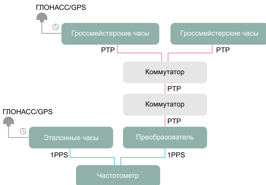
Рис. 4. Схема проверки локальной сети с поддержкой PTPv2
