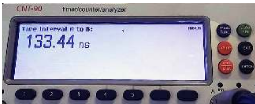
Рис. 5. Результат измерения абсолютной погрешности синхронизации
